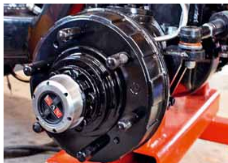
Il dispositivo di sblocco della trasmissione dei raccoglifrutta CT Wagon Lifted
